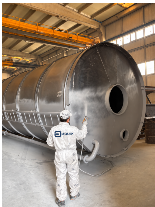
Peinture du silo - photo avec retouche de marque
